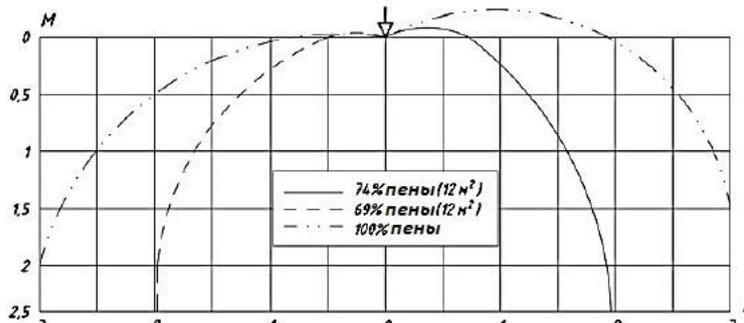
**График зависимости интенсивности орошения от давления на площади 12 м<sup>2</sup>, защищаемой одним оросителем с высоты 2,5 м**
